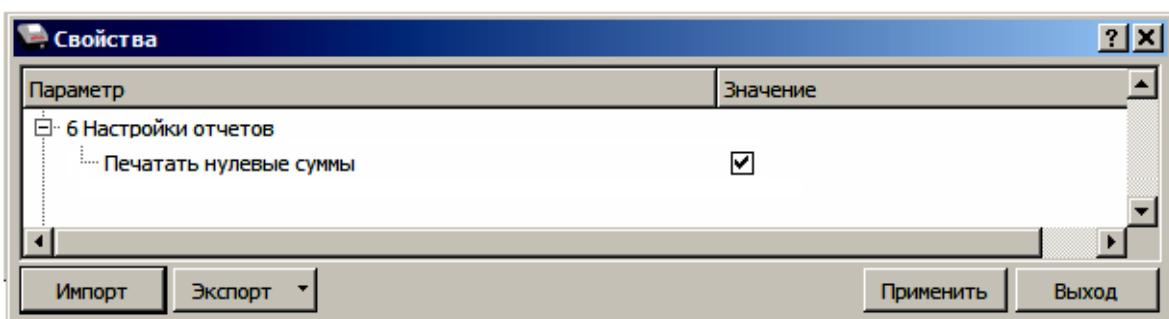
**Печатать нулевые суммы.** В данной ККТ по умолчанию в суточных отчетах печатаются и ненулевые суммы, и нулевые суммы приходов, возвратов приходов, расходов, возвратов расходов. Данная настройка предназначена для включения/отключения печати нулевых сумм. Если флаг установлен, то в суточных отчетах будут печататься нулевые суммы, в противном случае нулевые суммы печататься не будут.
