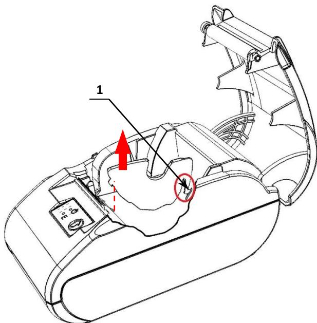
Рисунок 11. Извлечение фиксатора-защелки из паза в лотке ЧЛ
