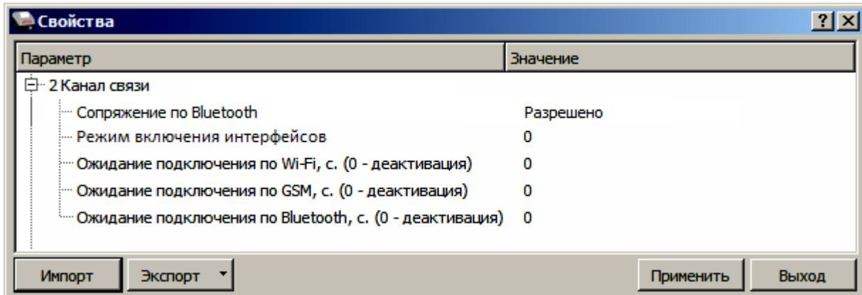
**Сопряжение по Bluetooth.** Настройка сопряжения с устройствами по интерфейсу Bluetooth. Параметр может принимать значения: **Разрешено** или **Запрещено**.
