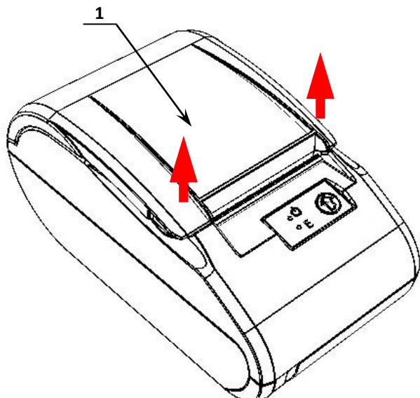
Рисунок 5. Места приложения усилий при открытии крышки
