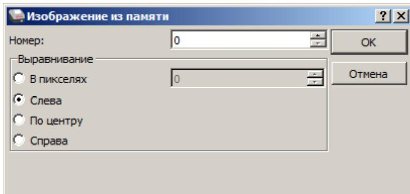
В поле **Номер** нужно указать номер изображения, в области **Выравнивание** можно указать выравнивание в пикселях: установить флаг напротив значения **В пикселях** (при этом поле
