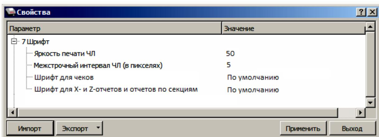
**Яркость печати ЧЛ.** Может принимать значения от 1 (минимальная) до 100 (максимальная). Яркость печати меняется при изменении температуры окружающей среды. Для того, чтобы на чеке изображение имело одинаковую яркость, при температуре воздуха +10 °C она должна быть больше, чем при температуре +35 °C.
