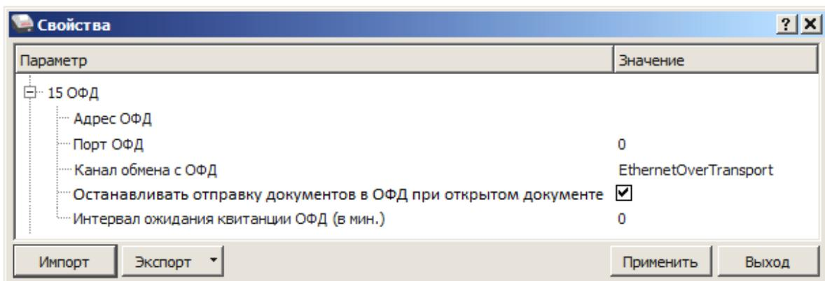
**Адрес ОФД.** В поле вводится адрес сервера (можно указать IP-адрес или URL-адрес сайта оператора).
