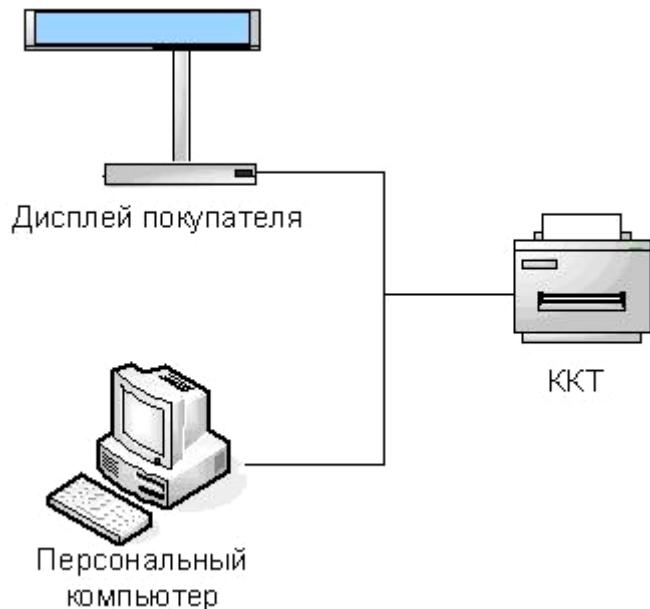
Рисунок 3. Подключение управляющих устройств к ККТ
