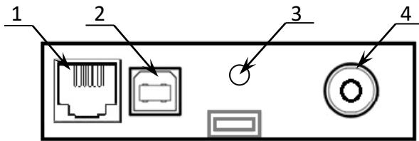
Рисунок 4. Разъемы для подключения внешних устройств к ККТ
