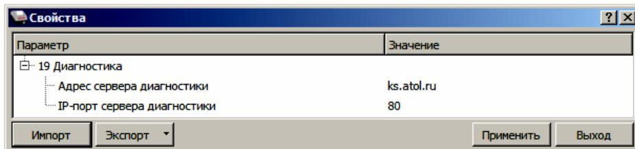
**Адрес сервера диагностики.** Параметр предназначен для программирования адреса сервера диагностики для последующего осуществления диагностирования связи ККТ с сервером диагностики.
